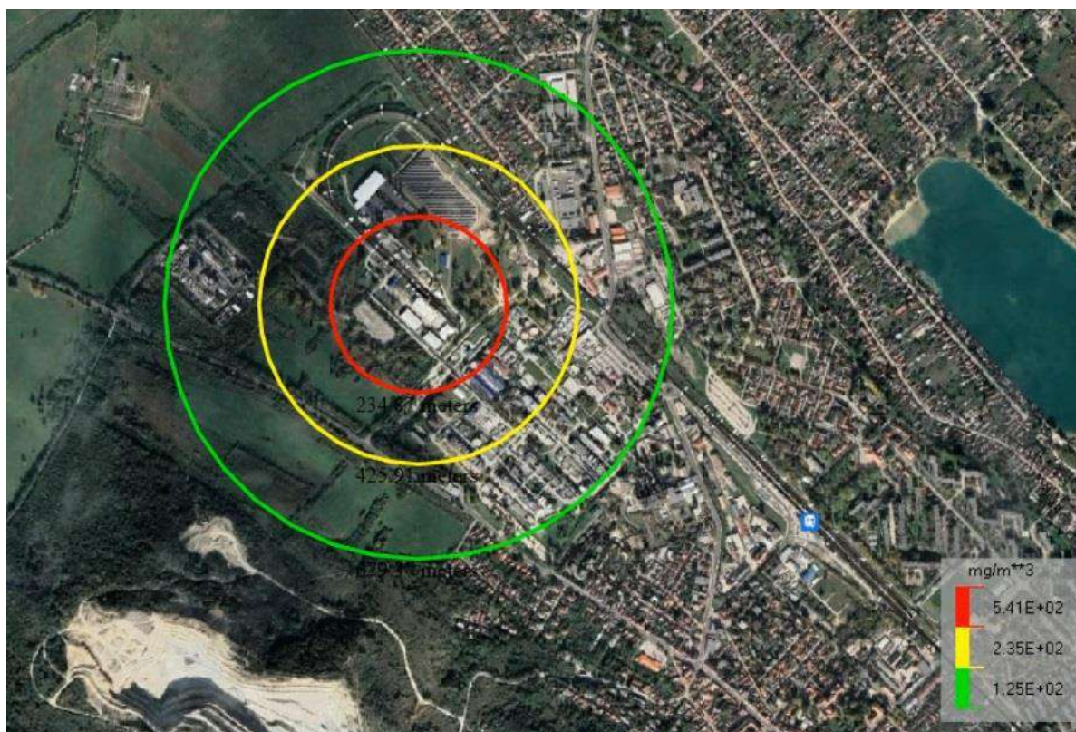
Nitrogén-oxid kibocsátás izokockázati görbéi
